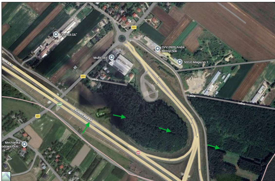
Ryc. 15. Przebieg korytarza ekologicznego z wykorzystaniem przejścia dolnego pod autostradą A4 (strzałki – kierunek migracji).
